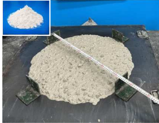
超低炭素型コンクリート (セメント材料の大部分を高炉スラグ微粉末にて置換)
